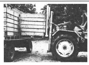
Hydr. Gabelstapler Muletto für Dreipunktaufhängung an Traktor. Leistungsfähig, vielseitig. Versch. Modelle mit Tragkraft ab 1000 kg. Seitenverschiebung, grosser Neigungswinkel, Gabeln äussere Breite regulierbar und aufklappbar.
