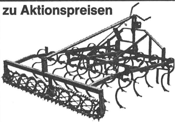
für 3-Punkt-Anbau, mit 4 Zinkenreihen und über Spindeln höhenverstellbarem Spitzzahn-Ein- oder -Zweiwalzenkrümmer.
