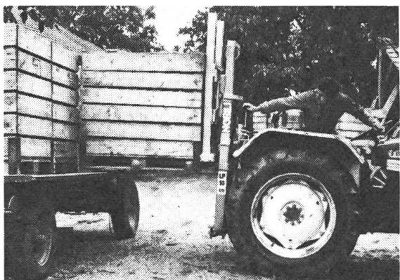
Hydr. Gabelstapler Muletto für Dreipunktaufhängung an Traktor. Leistungsfähig, vielseitig. Versch. Modelle mit Tragkraft ab 1000 kg. Seitenverschiebung, grosser Neigungswinkel, Gabeln äussere Breite regulierbar und aufklappbar.
