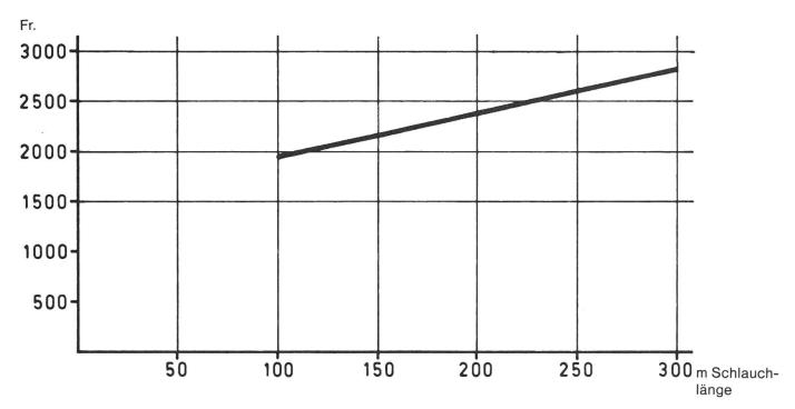
Abb. 5: Die Anlagekosten setzen sich aus dem Preis des Lüfters (Fr. 1500.–) und den Kosten des Schlauches (Fr. 4.40/lm) zusammen. Es muss berücksichtigt werden, dass die Kosten des Schlauches aufgrund der kurzen Lebensdauer nach zirka drei Jahren wieder anfallen.
