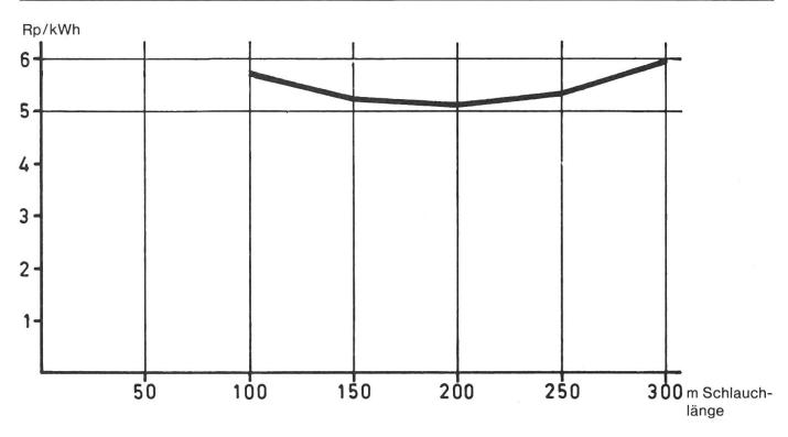
Abb. 7: Kosten je Kilowattstunde nach Länge. Die Verfahrenskosten je kWh sind bei 200 m Länge mit 5,1 Rp. am tiefsten. Der Schlauchkollektor liefert also die Energie etwa zum Nachtstromtarif.
