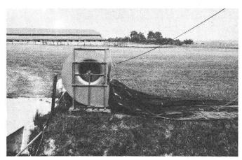
Abb. 2: Hier wurde der Heuventilator an den Schlauchanfang geflanscht. Diese Betriebsart empfiehlt sich nicht, da der grosse Gegendruck des Heustockes ein Reissen des Schlauches verursachen kann. Weiter ist eine Intervallbelüftung mit diesem System nicht möglich. Im Stillstand liegt der Schlauch bei beiden Betriebsarten flach auf der Wiese und bietet so Gewitterstürmen relativ kleine Angriffsflächen.
