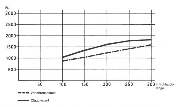
Abb. 6: Die jährlichen Kosten werden dem eingefangenen Energiewert gegenübergestellt. Es zeigt sich, dass der Schlauchkollektor schon ab 100 m Länge wirtschaftlich betrieben werden kann. Der wirtschaftlichste Bereich liegt bei 150 bis 250 m Länge.
