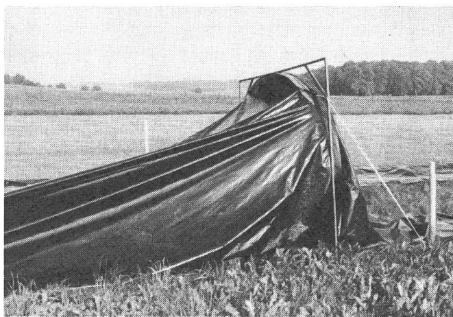
Abb.3: Das Zusammenkuppeln der verschiedenen 100 m langen Stücke mit Hilfe dieser Ringe hat sich nicht bewährt, da die Folie beim Stillstand des Lüfters an der Oberkante riss. Besser erwies sich ein Einführen des ersten Schlauchstückes in das zweite um zirka 3 m und die Fixierung desselben mit drei bis vier Ballastsäcken.
