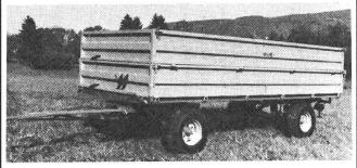
Brückeninnenmass 5,17 x 2,06 m Seitenladen 1 m Brückeninhalt 10.6 m<sup>3</sup> Gesamtgewicht 9 t Bereifung 11,5 x 15,12 Ply
