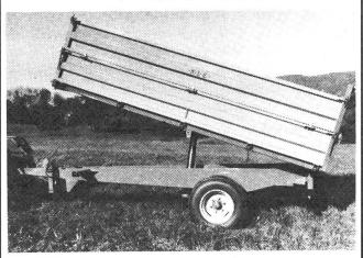
Brückeninnenmass 4,17 x 2,06 m Seitenladen 1 m Brückeninhalt 8,6 m3 Gesamtgewicht 8 t Bereifung 12 x 18 Stahlgürtel
