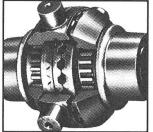
OPTITRAC bringt 100% Sperrwirkung bei Geradeausfahrt, mit automatischer Entriegelung bei Kurvenfahrt. Das macht den Allradantrieb noch wirkungsvoller. OPTITRAC ist wartungs- und verschleissfrei.
