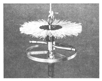
Der Schachtspüler für Fallrohre von mind. 500 mm Ø
