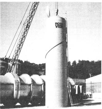
OROTAVER-Grünfuttersilo Ø2,5 m mit 50 m³ Inhalt anlässlich einer Dichtigkeitsprüfung mit Wasser.
