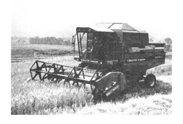
Mähwerk hat eine Standard-Arbeitsbreite von 4,20 m. Nach Wunsch sind auch Arbeitsbreiten von 3 m, 3,60 m und 4,80 m lieferbar. Der Korntank hat ein Fassungsvermögen von 5000 l, der 5teilige Hordenschüttler eine Fläche von 5,78 m² und der Dreschkorb eine Abscheidefläche von 0,75 m².
