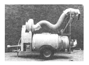
Hochleistungs-Sprüh- und -Spritzgerät ist durch Verwendung von Polyester, Aluminium und Rostfreistahl absolut korrosionbeständig. Zur Wahl stehen gezogene Modelle mit einem Tankinhalt von 600–1200 Litern und eine Aufbaueinheit mit einem Inhalt von 450 Litern.
