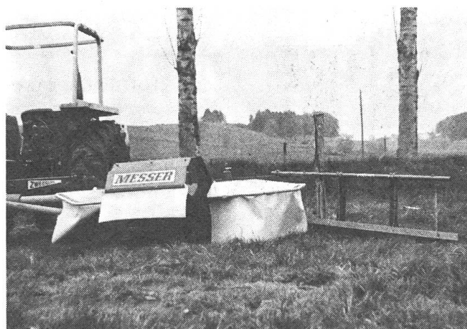
Ansicht des Tierschutzgerätes von hinten. Deutlich sieht man, wie der Verlängerungsarm einem Pfosten ausweichen kann weil ein Drehgelenk es dem Schutzgerät ermöglicht nach hinten zu kippen.
