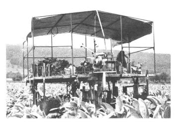
Abb. 5: Tabakerntemaschine «Karussell» an der Arbeit in Aesch LU.
