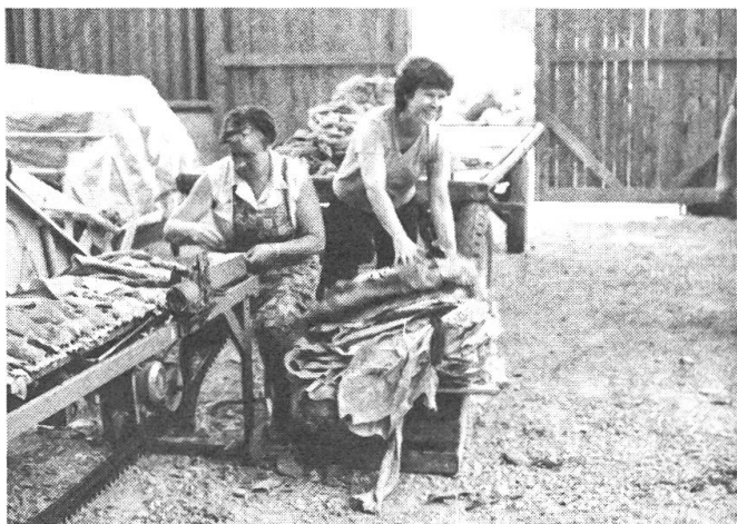
Abb. 7: Das Anziehen der Blätter erfolgt heute überall mit der gleichen Maschine.
