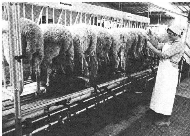
schine und zwar wird durch ein Massage-/Saugverhältnis von 1:1 der höchste Wirkungsgrad erreicht.
