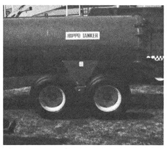
Abb. 2.: Frei nachlaufende Tandemachse. (Foto: W. Bühler)
