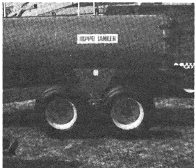
Abb. 2.: Frei nachlaufende Tandemachse. (Foto: W. Bühler)
