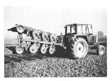
Abb. 1: Das sollte wohl der Vergangenheit angehören: Ein 88-kW-Traktor ohne zusätzlichen Vorderradantrieb!
