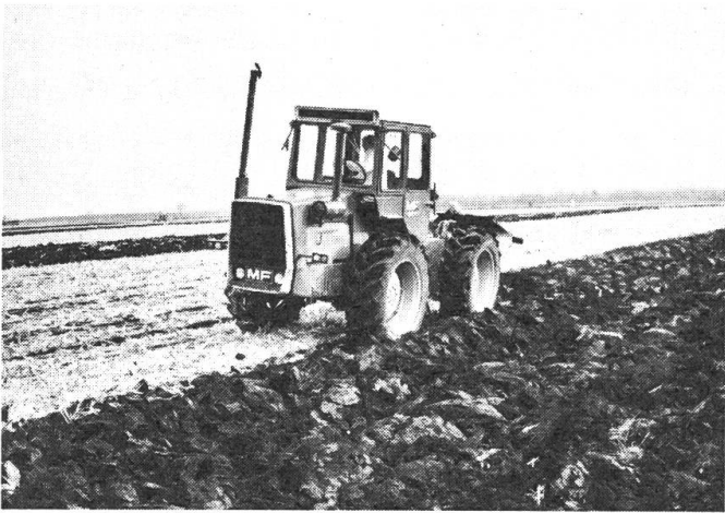
Abb. 3: Der sogenannte Knickschlepper will sich bei uns in Europa nicht so recht durchsetzen.
