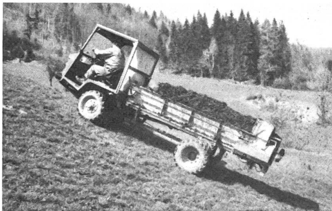
Abb. 6: Die Universal-Transporter für den Grünland-Hangbetrieb sind selbstverständlich mit Allradantrieb ausgerüstet.
