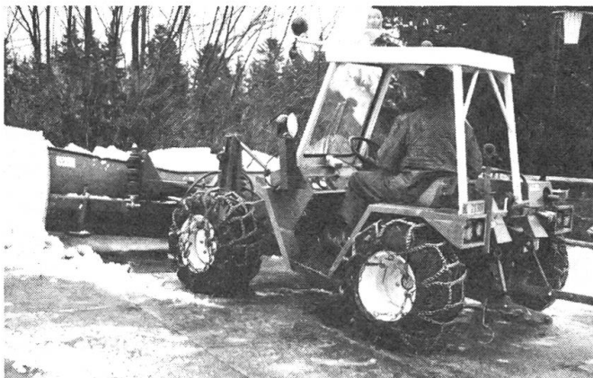
Abb. 4: Für eine vernünftige Schneeräumung ist der Allradantrieb unbedingt notwendig.
