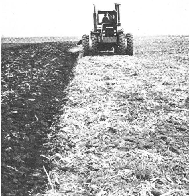
Abb. 5: Diese Art des Pflügens bzw. das Fahren neben der Furche erfordert eine sehr gute Zugkraftausrüstung.
