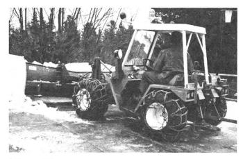
Abb. 4: Für eine vernünftige Schneeräumung ist der Allradantrieb unbedingt notwendig.
