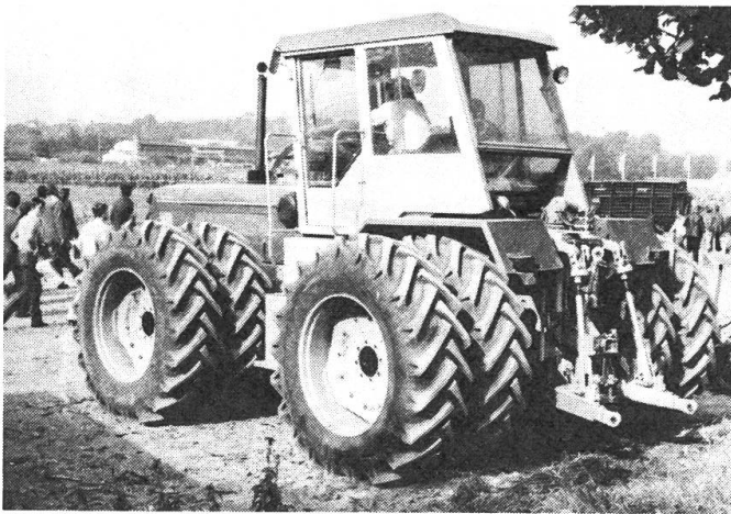
Abb. 2: Man tut alles, um die Motorleistung bei gezogenen Geräten über die Räder auf den Boden zu bringen.
