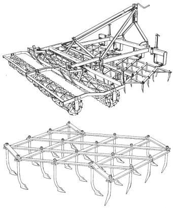
Abb. 1: Zweifelder-Zinkenegge mit zweireihigem Zahnstangenkrümler, unten ein Löffeleggefeld.
