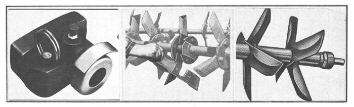
Abb. 8: Links: mittels Bolzen lässt sich der Schnittwinkel von Spatenwellen schnell verstellen. Mitte: die Spaten werden kreuzweise mit Schrauben an einem Flansch befestigt oder an einer Vierkantwelle (rechts) eingeschoben.
