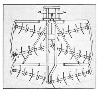
Abb. 6: Schema einer Spatenrollegge mit sechs Spatenwellen – in drei Reihen angeordnet. Der Schnittwinkel der vorderen zwei Spatenwellen-Reihen ist in drei Stufen verstellbar.
