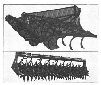
Abb. 4: Kombination von Tief- und Feingrubber mit einem einreihigen Zahnstangenkrümler. Unten: zweireihige Sternkrümlerwalze (Doppelsternkrümler).
