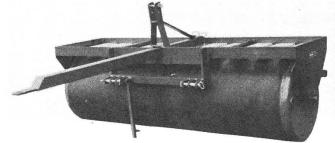
Abb. 13: Glattwalze mit Dreipunkt-Anbaurahmen und Deichsel. Durch die Wasserfüllung in die zwei Zylinder kann ihr Gewicht und damit ihre Wirksamkeit erhöht werden.
