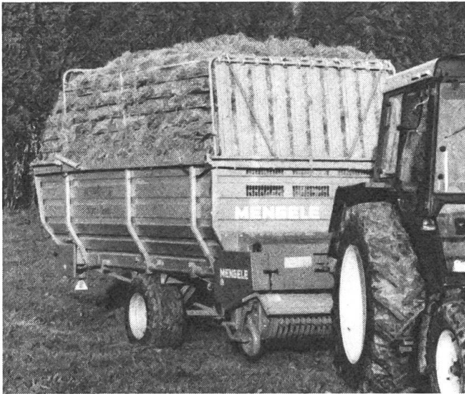
Menele LW 310 S Quadro mit 27 m 3 Fassungsvermögen und hydraulischer Schwenkdeichsel (Werkfoto Mengele)
