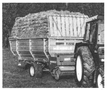
Mengele LW 310 S Quadro mit 27 m³ Fassungsvermögen und hydraulischer Schwenkdeichsel (Werkfoto Mengele)
