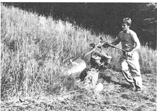
Der Umbau vom Balken- zum Bandheuer geht spielend leicht, da das neue Evolventen-Profil der Antriebswelle beim Anschliessen immer passt. Natürlich können die Anbaugeräte der Vorgängermodelle AM 7 und AM 8 wieder verwendet werden. Sie lassen sich mit geringem Aufwand anpassen.
