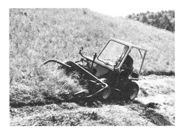
Bandrechen 1,8 m am hydraulischen Front-3-Punkt und mit gezogenem Kreiselheuer oder kleinem Anhänger.
