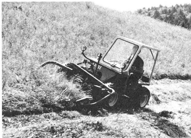
Bandrechen 1,8 m am hydraulischen Front-3-Punkt und mit gezogenem Kreiselheuer oder kleinem Anhänger.
