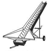
Gummi-Förderbänder Gurt flach, muldenförmig oder Wellenkante
