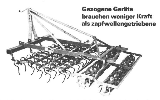
Durch den Einsatz von RAU-Geräten wird der Boden gleich tief gelockert, eingeebnet, gekrümelt, gemischt und rückverfestigt. Es entsteht ein hervorragendes Saatbett.
