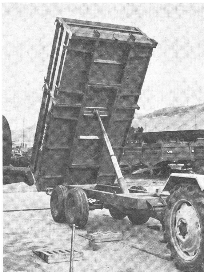
Abb. 8: Kipper mit sehr hohem Ölbedarf (zum Beispiel 17 l). Nicht allen Traktoren kann soviel Öl abgezapft werden.
