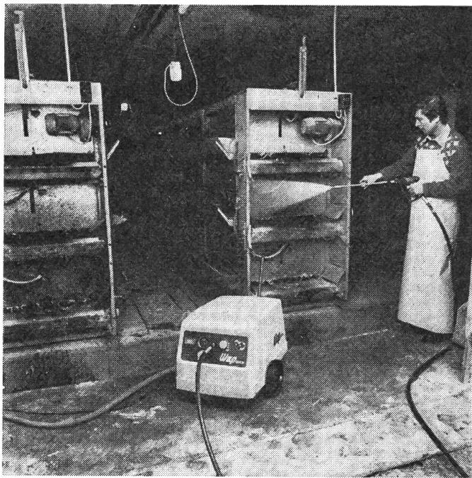
sier- und Desinfektionssystem ausgestattet, so dass jederzeit die erforderlichen chemischen Produkte zugegeben werden können. Soll mit Warmwasser gearbeitet werden – oft Forderungen der Intensiv-Viehhaltung – dann kann der WAP-Quick an die meist festinstallierte Warmwasserversorgungsanlage des landw. Betriebes angeschlossen werden. Sind solche Voraussetzungen nicht gegeben, ist der WAP C-750 empfehlenswert – eine leistungsstarke Heisswasser-Hochdruckreinigungsmaschine.
