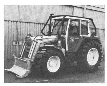
STEYR-Forsttraktor FT 80 ausgerüstet mit Doppeltrommelseilwinde 2 x 5500 kg Zugleistung und Frontpolderschild.
