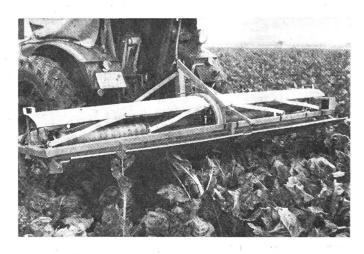
Abb. 1: Mittels eines walzenartigen Gerätes werden die Schosser mit einem Totalherbizid benetzt; die Schosser sterben dann ab.
