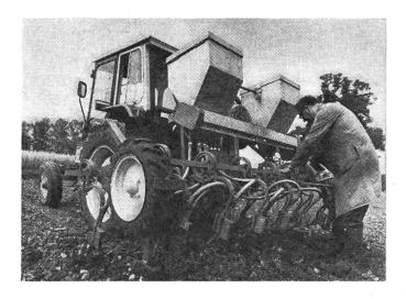
Die durch einen Traktor gezogene Maschine (ein Granulatstreuer) setzt für Nematoden tödliches Granulat in senkrechten Streifen in den Boden ein. Dieser Vorgang (nachdem der Boden mit einer Rollegge mit senkrechten Zinken bearbeitet wurde) bedingt eine gleichmässige Verteilung des Granulats bis zu einer Tiefe von 15 cm, wo die Nematoden am besten bekämpft werden.
