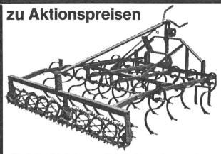
für 3-Punkt-Anbau, mit 4 Zinkenreihen und über Spindeln höhenverstellbarem Spitzzahn-Ein- oder -Zweiwalzenkrümler.
