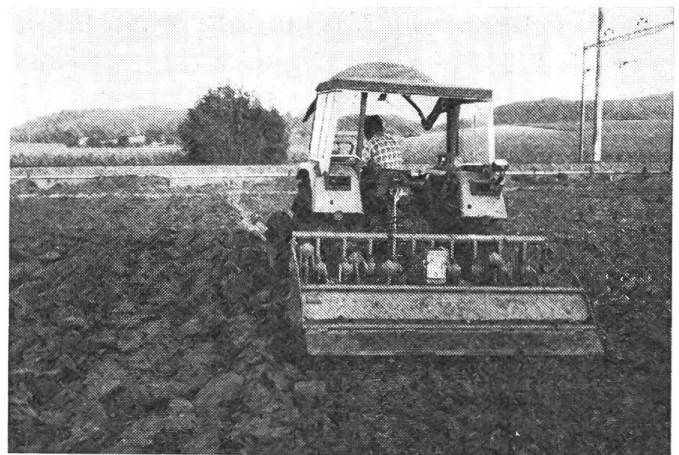
Abb. 1: Eine Pendelspatenmaschine bearbeitet den Boden feiner und ohne Verdichtung; auf dem Bild links Pflugfurche.
