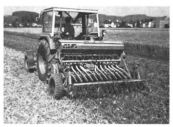
Abb. 4: Feldbestellung mit der Frässämaschine; die hinten angebrachte Krümlerwalze trägt zur Wiederherstellung des Bodenschlusses und damit zur Verbesserung der Aufgangsbedingungen bei.
