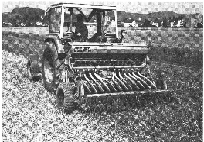
Abb. 4: Feldbestellung mit der Frässämaschine; die hinten angebrachte Krümlerwalze trägt zur Wiederherstellung des Bodenschlusses und damit zur Verbesserung der Aufgangsbedingungen bei.
