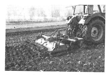
Abb. 3: Wird ein Grubber mit einer Fräse als Nachlaufgerät ausgerüstet, so lässt sich das Feld unter Umständen in einem Durchgang saatfertig bestellen. Eine solche Kombination erfordert allerdings Traktoren über 59 kW (80 PS) Motorleistung.
