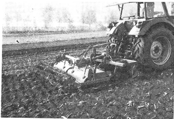
Abb. 3: Wird ein Grubber mit einer Fräse als Nachlaufgerät ausgerüstet, so lässt sich das Feld unter Umständen in einem Durchgang saatkünftig bestellen. Eine solche Kombination erfordert allerdings Traktoren über 59 kW (80 PS) Motorleistung.
