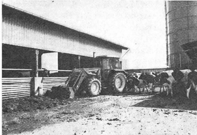
Diese Frontlader verteilen die schweren Lasten auf den gesamten Traktorrahmen, anstatt sie auf einige wenige Punkte zu übertragen. Automatische Parallelstellung der Ladeschaufel und hydraulische Einhebelbedienung beschleunigen die Arbeitsgänge.
