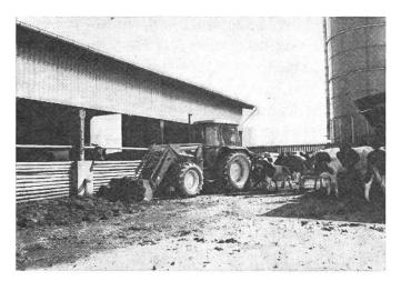
Diese Frontlader verteilen die schweren Lasten auf den gesamten Traktorrahmen, anstatt sie auf einige wenige Punkte zu übertragen. Automatische Parallelstellung der Ladeschaufel und hydraulische Einhebelbedienung beschleunigen die Arbeitsgänge.
