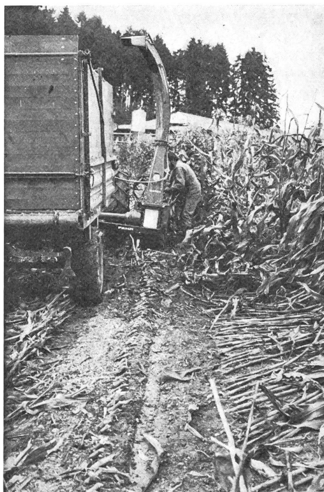
Abb. 3: Eine Rückdrehvorrichtung wird vor allem im Lagermais geschätzt, um Verstopfungen zu beheben.
