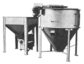
Mahl- und Mischanlage Hagemix 75 und Hagemix 100, mit Hammermühle, 750-kg-Schnellmischer, automatischer Leerlaufabschaltung, Vorbehälter mit Förderleitung und Filter. Kann auch getrennt montiert werden. 120/21
