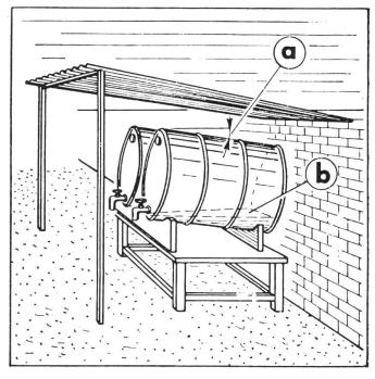
Abb. 1: Behälteraufstellung zum Dekantieren des Dieseltreibstoffes.
