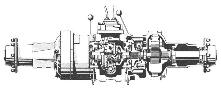
Abb. 4: Differentialgetriebe mit Hinterachse. Hier wird in den meisten Fällen ein Öl der MIL-Spezifikation MIL-L-2105 B/C vorgeschrieben. Als API-Spezifikation wird GL 5 genannt. Die Viskosität ist in den meisten Fällen SAE 90.
