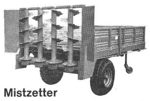
von 2 t bis 6 t, mit 2 oder 4 stehenden Streuwalzen, Gelenkwelle, Beleuchtungsanlage, Bremsachsen, Bereifung 10 x 15, 11,50–15, 130/65–18. Metallaufbau, robuste Konstruktion, Dosierung von Sitz aus möglich.
