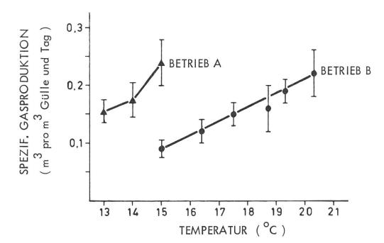
Abb. 3: Die spezifische Gasproduktion in Funktion der Gärtemperatur, welche in Gruppen von 1º C zusammengefasst wurde.
