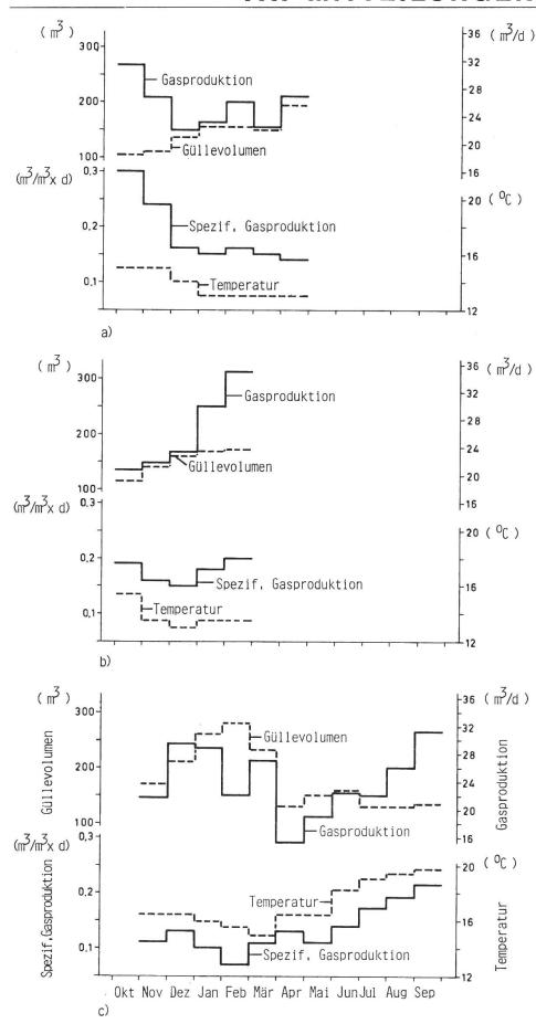
Abb. 2 (a-c): Monatliche Durchschnitte der täglichen Gasproduktion, des Güllevolumens, der Gärtemperatur und der spezifischen Gasproduktion.
