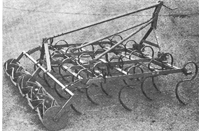
Ein- oder Zweiwalzenkrümler mit Zahnsteg- oder Sternprofil. Die Krümler haben einen grossen Durchmesser und jede Reihe ist mit 4 einwandfrei abgedichteten **im Zentralrohr integrierten Speziallagern** ausgerüstet. Lieferbar in Arbeitsbreiten von 2,1 bis 8,5 m, auch klappbar mit Federzug oder hydraulisch.
