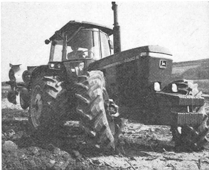
Abb. 3: Dank einem übergrossen Nachlaufwinkel neigt sich das Innenrad bei Kurvenfahrt vom Fahrgestell weg. Dies ermöglicht besseren Radeinschlag und ungewohnt kleinen Wendekreis.
