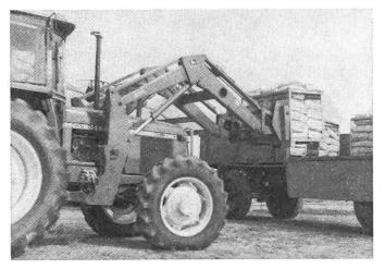
Abb. 4: Der Frontlader mit automatischer Parallelführung eignet sich neben allen bekannten Arbeiten auch zum manövrieren von geeigneten Paletten. Ohne fremde Hilfe braucht der Fahrer für den Anoder Abbau weniger als 5 Minuten.
