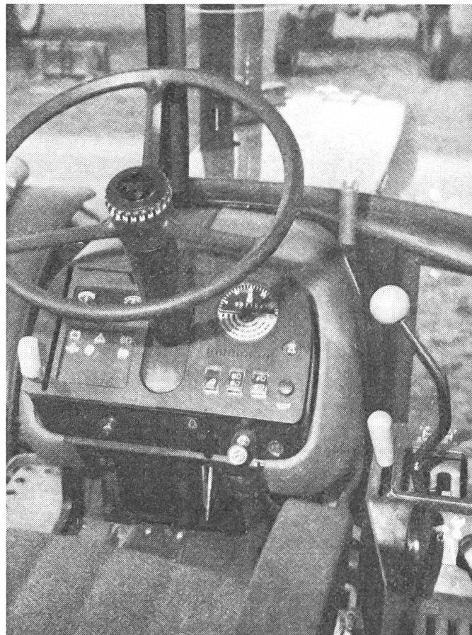
Abb. 2: Die Reflexfreie Frontscheibe unterdrückt dank ihrer Wölbung die Eigenschwingungen. Dadurch hilft sie mit, den Innenlärm zu dämpfen. Alle Schaltorgane liegen in Griffnähe des Fahrers.
