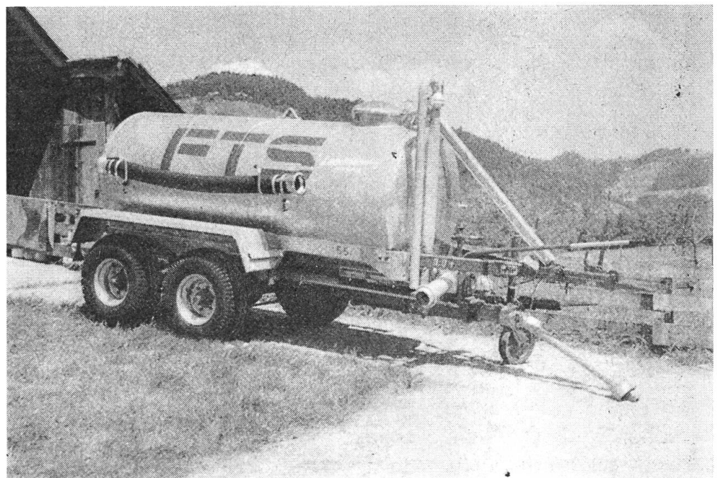
Abb. 4: Pumpfässer eignen sich besonders da, wo steile Felder in grösserer Entfernung vom Hof liegen und nur über eine Weitwurfdüse oder eine Verschlauchung begüllet werden können.
