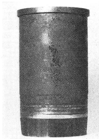
Korrosionsgeschädigte Zylinderlaufbüchse durch Verwendung von Wasser als Kühlmittel. Langzeitfüllung bringt Abhilfe.
