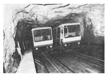
In Abb. 2 wird die Steigung deutlich, die für eine imponierende Leistung der grössten Standseilbahn der Welt jedoch kein Hindernis bildet: 200 Personen werden in 3 Minuten Fahrzeit mit 10 m/sec. 700 Meter hinauf oder hinunter transportiert!
