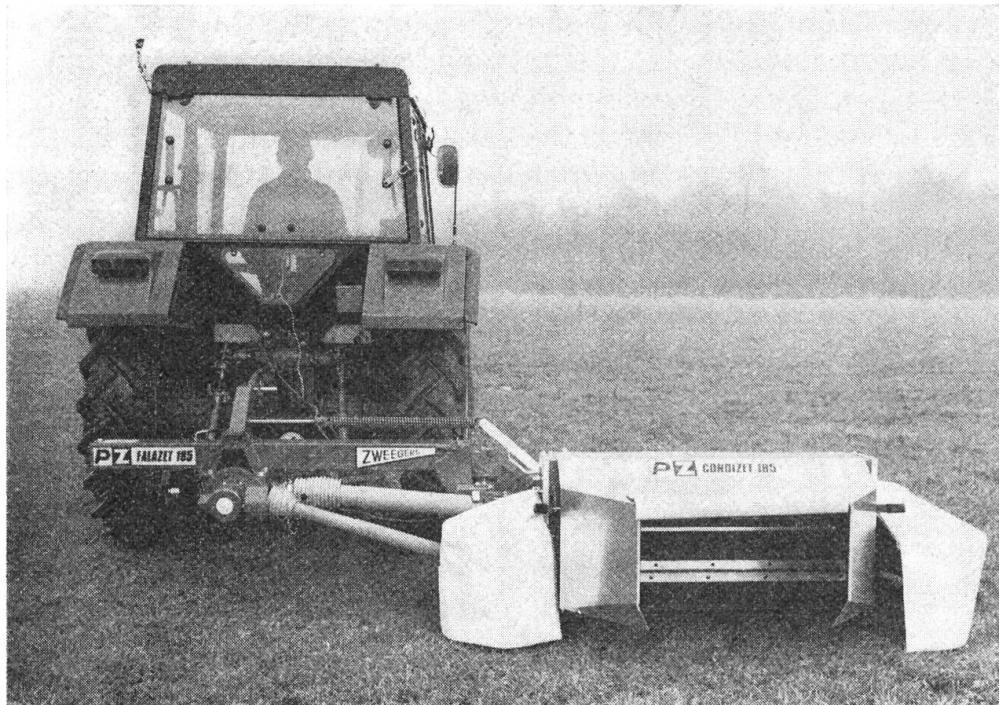
An- und Abbau des Condizet-Aufbereiters erfolgen mühelos und rasch: Es sind nur zwei Stecksplinten zu lösen und die Gelenkwelle abzukuppeln. Je nach Bedarf kann also das Falazet-Mähwerk mit oder ohne Aufbereiter eingesetzt werden.
