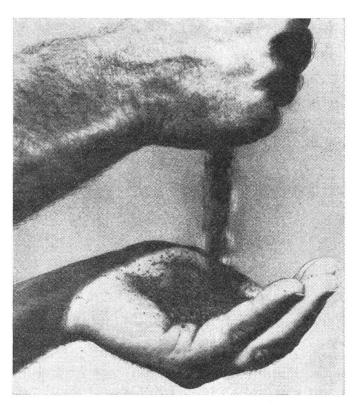
Abb. 2: Ein typisches Endprodukt des Brill Digesters: ein trockenes, luftiges und geruchloses 2-2-2-Düngemittel oder ein proteinreiches Kraftfutter. Das abgebildete Muster entstand aus einem Gemisch von Hühnermist und Sägemehl.
