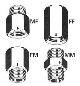
Abb. 2: DRV mit Gewinde. Der Pfeil gibt die Flussrichtung an. M = Aussengewinde. F = Innengewinde. Der erste Buchstabe weist auf die Einflussstelle hin.
