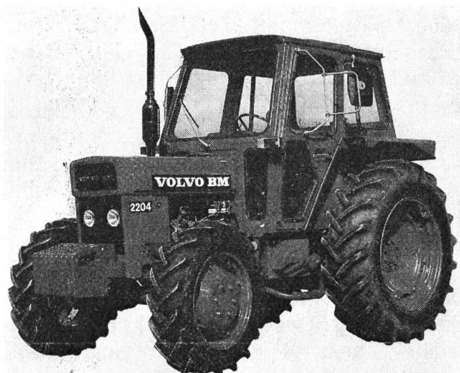
Die Modelle BM 2200/2204 sind kleine Traktoren, die auch Schwerarbeit schaffen. Ihre Antriebe sind direkteingespritzte Vierzylinder-Dieselmotoren mit 56 PS (40,5 kW). Die Kraftübertragung übernimmt ein vollsynchroisiertes Achtganggetriebe, das auch mit hydraulischem Schnellgang erhältlich ist. Der BM 2204 ist die Allradausführung. Die beiden Typen BM 2250/2254 mit 68 PS (49,5 kW) entsprechen in der Ausführung den Traktoren BM 2200/2204.
