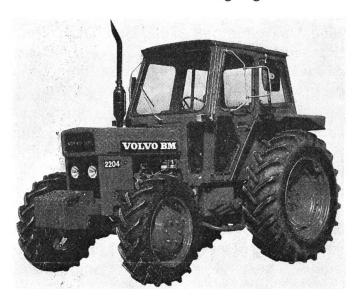
Die Modelle BM 2200/2204 sind kleine Traktoren, die auch Schwerarbeit schaffen. Ihre Antriebe sind direkteingespritzte Vierzylinder-Dieselmotoren mit 56 PS (40,5 kW). Die Kraftübertragung übernimmt ein vollsynchronisiertes Achtganggetriebe, das auch mit hydraulischem Schnellgang erhältlich ist. Der BM 2204 ist die Allradausführung. Die beiden Typen BM 2250/2254 mit 68 PS (49,5 kW) entsprechen in der Ausführung den Traktoren BM 2200/2204.
