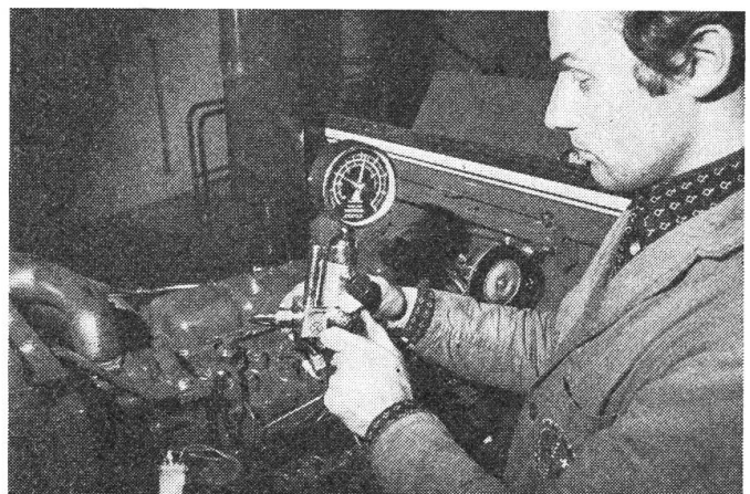
Abb. 41: Ueberprüfen der Einspritzpumpe und der Einspritzdüsen mit dem Injekttester.
