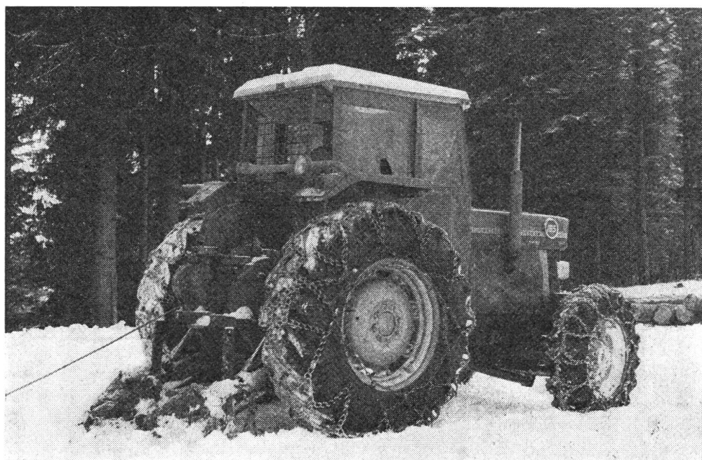
Abb. 1: Zur Sicherheit des Maschinenführers und seiner Arbeitskollegen ist das Rückefahrzeug mit Sicherheitskabine, -rahmen oder -bügel, Gesundheits-sitz, Heckschutzgitter, Seilwinde und Rückeschild auszurüsten.
