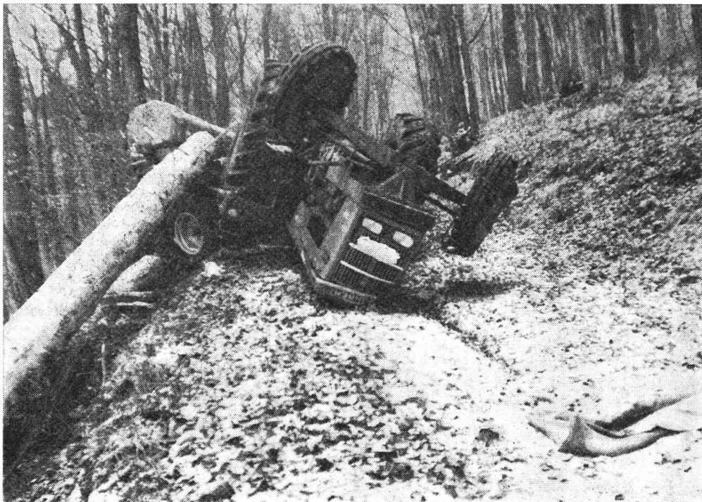
Abb. 4: Ein mit Trämeln beladener Wagen mit Auflaufbrem- sen konnte auf der nassen, mit Laub bedeck- ten und leicht ver- schneiten Strasse nicht mehr gebremst werden.
