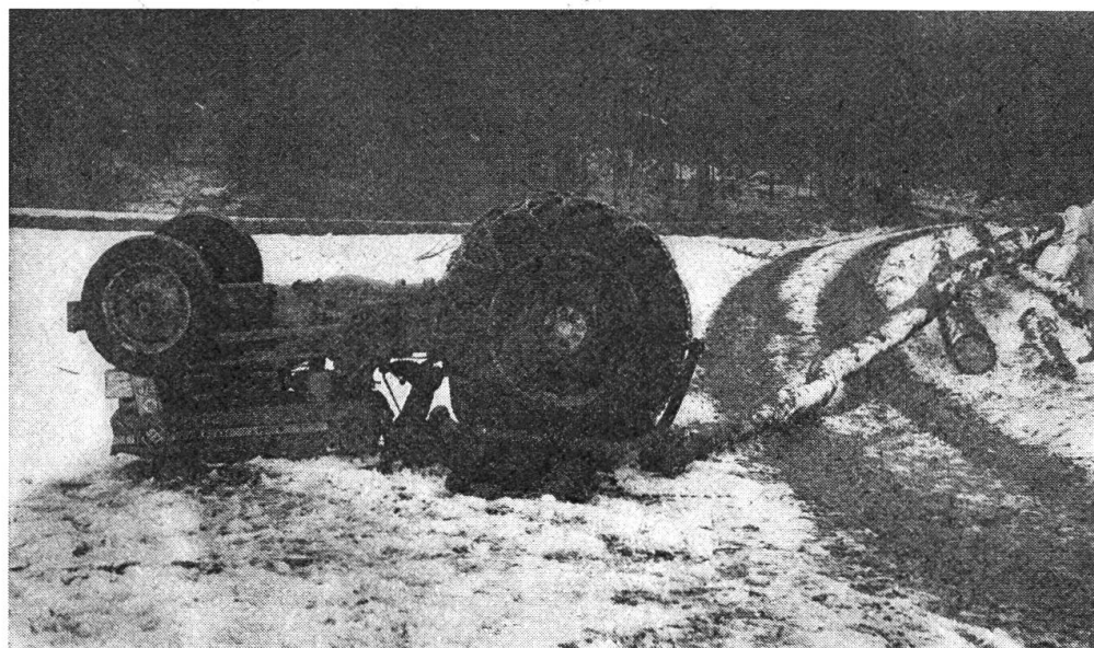
Abb. 2: Tödlicher Traktorsturz wegen zu hohem Anhängpunkt (nachstossender Stamm).
