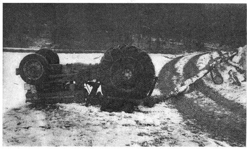
Abb. 2: Tödlicher Traktorsturz wegen zu hohem Anhängepunkt (nachstossender Stamm).
