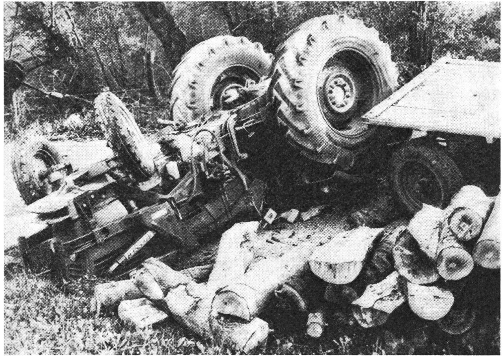
Abb. 3: Ungenügende Bremsen (Spindelbremsen) beim Brennholztransport ver- ursachten einen Unfall mit einem Toten und drei Schwerverletzten.
