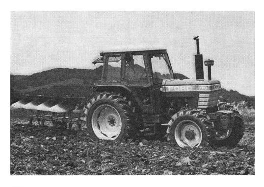
Abb. 1: Modell 7710 mit 4 Zylinder Turbo Dieselmotor, 4303 cm³, Lenktriebachse mit Differentialsperre, Zentralantrieb mit 52 Grad Einschlag. 16 Vorwärtsund 8 Rückwärtsgänge, Ford Originalkabine (82dBA).
