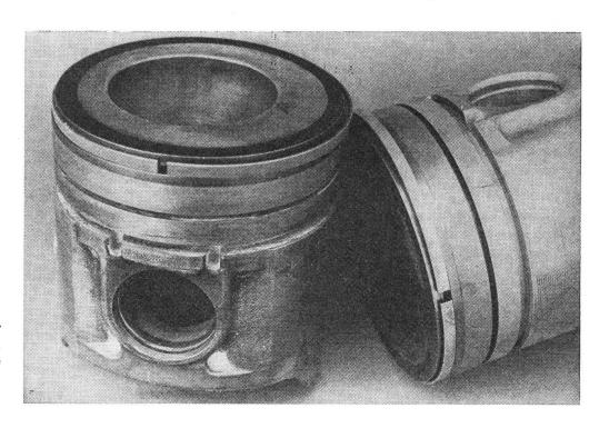
Abb. 2: Spezielle Kolben ergeben eine höhere Wirtschaftlichkeit durch bessere Verbrennung des Treibstoffes. Beachtenswert ist die neue Anordnung des Kompressionsringes.
