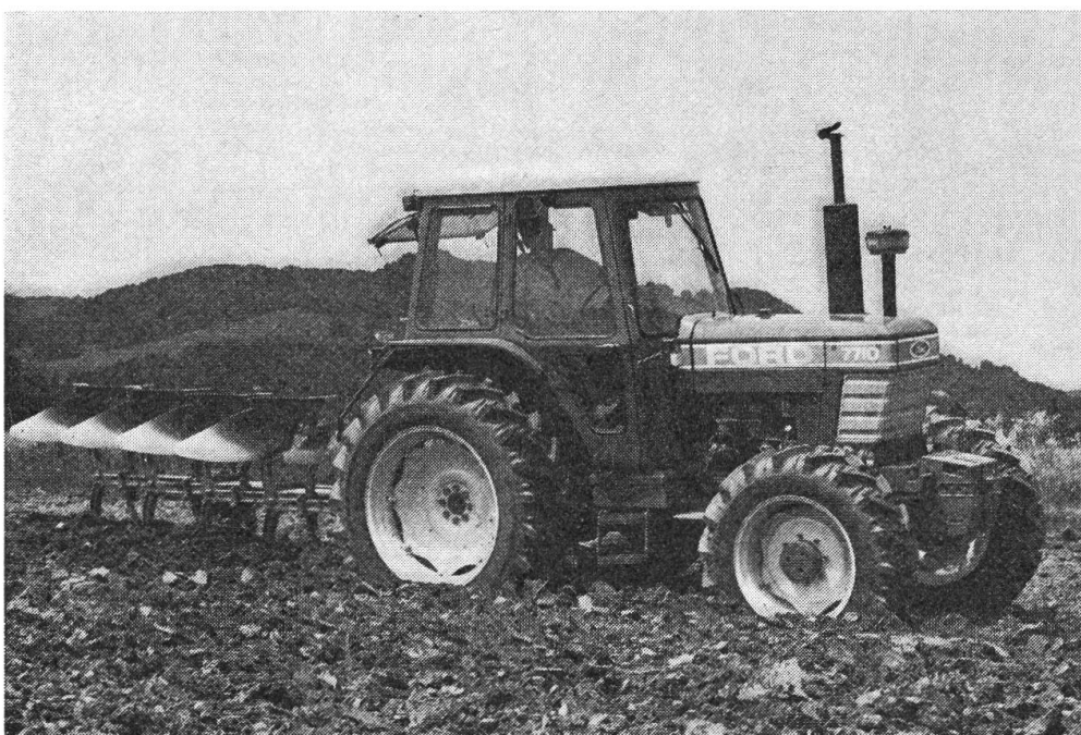
Abb. 1: Modell 7710 mit 4 Zylinder Turbo Dieselmotor, 4303 cm 3 , Lenktriebachse mit Differentialsperre, Zentralantrieb mit 52 Grad Einschlag, 16 Vorwärts- und 8 Rückwärtsgänge, Ford Originalkabine (82dBA).
