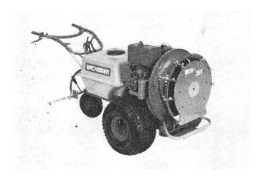
Die Aufsitz-Gebläsespritze MINIMOTRA bleibt unverändert. Der echte Vierrad-Antrieb, das sichere Reversiergetriebe und die ausgezeichneten Bremsen begeistern jeden Weinbauer. Neu wird diese Maschine mit einem elektrischen Anlasser geliefert.
