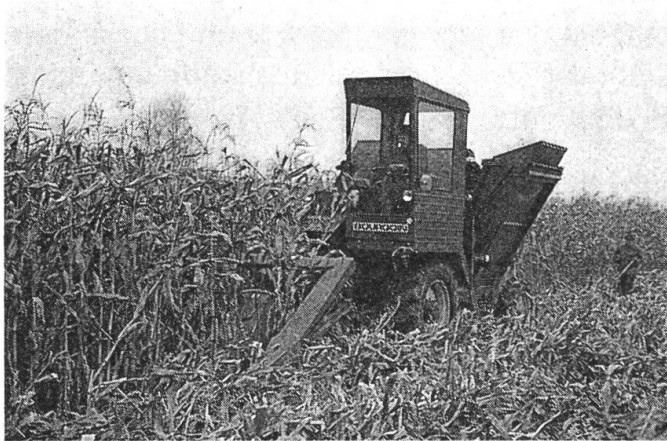
Abb. 2: Selbstfahrender, zweireihiger Kolbenpflücker bei der Arbeit.
