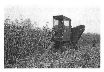
Abb. 2: Selbstfahrender, zweireihiger Kolbenpflücker bei der Arbeit.
