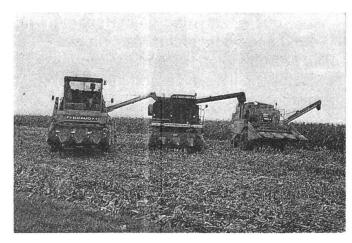
Abb. 3: Spezialmaisdrescher, Axialmähdrescher und konventioneller Mähdrescher (alle mit vierreihigem Pflückvorsatz) nach dem Vergleichseinsatz.
