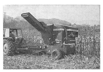
Abb. 5: Zweireihiger Spezialpflückschroter beim prüfungsmässigen Einsatz.
