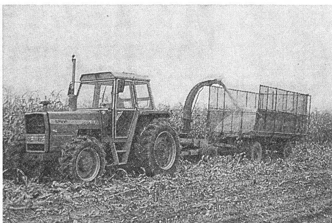
Abb. 7: Gehaltmässig das gleiche Produkt (Rohfasergehalt 9–11%) aber mit vollständig zerkleinerten Lieschen liefert der Trommelfeldhäcksler mit Recuttereinsatz. Da die Zerkleinerung der Lieschen einen hohen zusätzlichen Leistungsbedarf erfordert, kommt man selbst mit Traktoren der 100-kW-Klasse und zweireihigem Pflückvorsatz nur auf Flächenleistungen von ca. 20 a/h.
