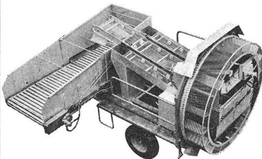
SAMRO-Vollernter sind wahlweise mit **Absackstand/Plattform**, mit **Kippbunker 1,6 t** oder mit **Rollbodenbunker 1,2/1,8 t** lieferbar. Absackungsmöglichkeiten in den Bunkern.
