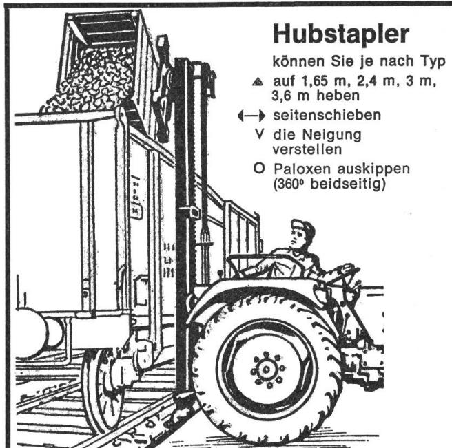
Für jeden Betrieb ein passender Typ, Baukastensystem
