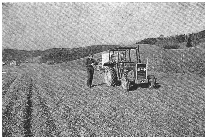
Abb. 4: Die gewählte Geschwindigkeit muss auch bei modernsten Druckregelarmaturen am Traktor erreicht werden. Auf die Angaben am Traktometer ist in der Regel kein Verlass (sehr grobe Richtwerte!). Bei den heute üblichen Mengenteilern oder automatischen Gleichdruckeinrichtungen kann die Geschwindigkeit (und damit die Zapfwellendrehzahl) etwas erhöht oder erniedrigt werden. Wegen zu geringem Rücklauf (Rührwerk) darf aber keinesfalls mit halber Drehzahl gefahren werden. Ebenso darf niemals der Gang gewechselt werden!
