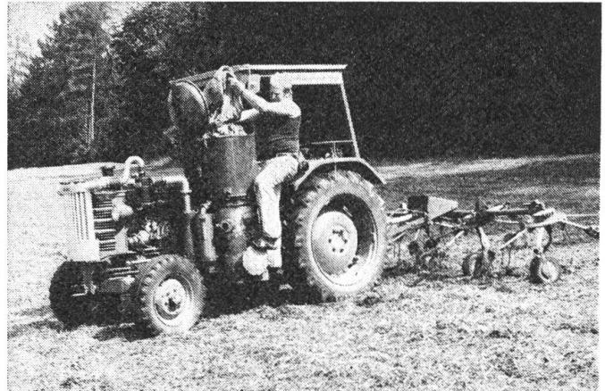
Landwirtschaftstraktor Hürlimann Typ D 110, umgebaut auf Diesel / Holzgasbetrieb. 4,5 kg Holz ersetzen im Durchschnitt einen Liter Dieseltreibstoff.
