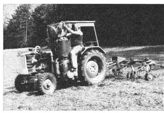
Landwirtschaftstraktor Hürlimann Typ D 110, umgebaut auf Diesel / Holzgasbetrieb. 4,5 kg Holz ersetzen im Durchschnitt einen Liter Dieseltreibstoff.
