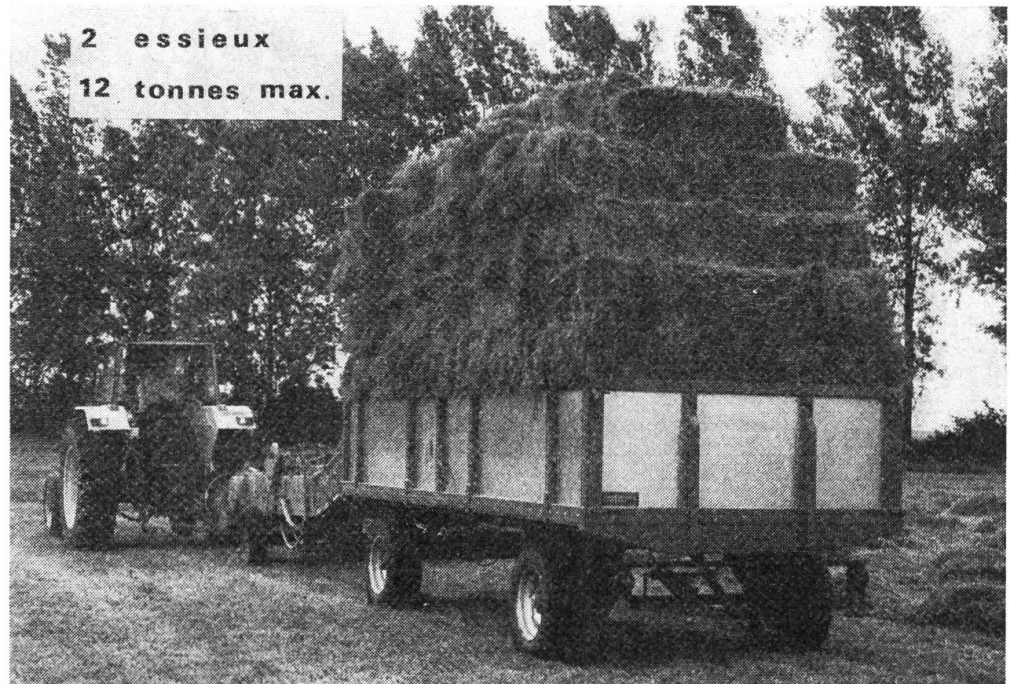
2-Achsanhängen, Gesamt- gewicht (Anhänger und Ladung): maximal 12 t
