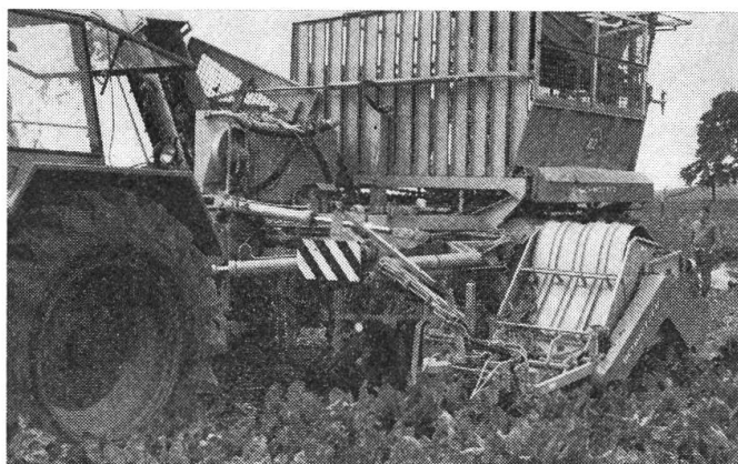
Abb. 3: Zweireihiger gezogener SCHMOTZER-Vollernter mit Radtastköpfer und Blattüberlade-Elevator. Diese Maschine bearbeitet gleichzeitig vier Rübenreihen (Ansicht von hinten in Abb. 1).
