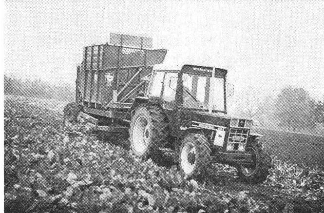
Abb. 7: Zweireihiges Ernteverfahren in zwei Phasen mit EGLI-Radtastköpfer und Rodebunker THYREGOD.
