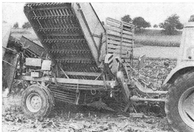
Abb. 6: Der Vollernter FRIED 450 F ist als einzige einreihige Maschine mit zwei Siebrädern ausgerüstet.
