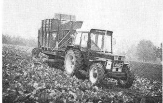
Abb. 7: Zweireihiges Ernteverfahren in zwei Phasen mit EGLI-Radtastköpfer und Rodebunker THYREGOD.
