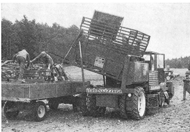
Abb. 2: Dieser zweireihige Selbstfahrer von ITALO-SVIZZERA stand in der Schweiz zum ersten Mal im Einsatz. Wie bei den einreihigen Typen dieses Herstellers werden alle Aggregate mit Hydraulikmotoren angetrieben.
