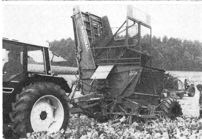
Abb. 8: Beim zweiphasigen Verfahren von RATIONAL (zwei- oder dreireihig) wird im ersten Arbeitsgang ein Kreiselköpfer mit Ueberladegebläse eingesetzt. Die Nachköpf- und Putzeraggregate sind vor den Rodescharen der Bunkermaschine angebracht. Für die einphasige Ernte ohne Blattbergung besteht die Möglichkeit, einen entsprechenden hydraulisch angetriebenen Kreiselköpfer front-seitlich an den Traktor des Rodebunkers zu montieren.
