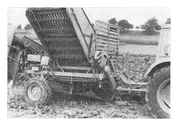
Abb. 6: Der Vollernter FRIED 450 F ist als einzige einreihige Maschine mit zwei Siebrädern ausgerüstet.
