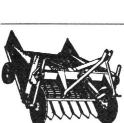
**RG** Hochleistungsmaschine für den Grossbetrieb; mit Kipp- oder Rollbodenbunker, Inhalt 1600/2000 kg.
