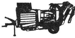
**RK** Für kleinere Betriebe; mit Ladefläche, Kipp- oder Rollbodenbunker, Inhalt 1300/1500 kg.
