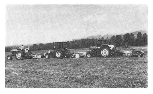
Ein Teil des vielseitigen PZ-Angebotes. Rotormäher 1,85 m mit aufgebautem Knicker. Falazet 1,85 m mit aufgebautem Walzenquetscher. Falazet 2,3 m mit gezogenem Knicker.
