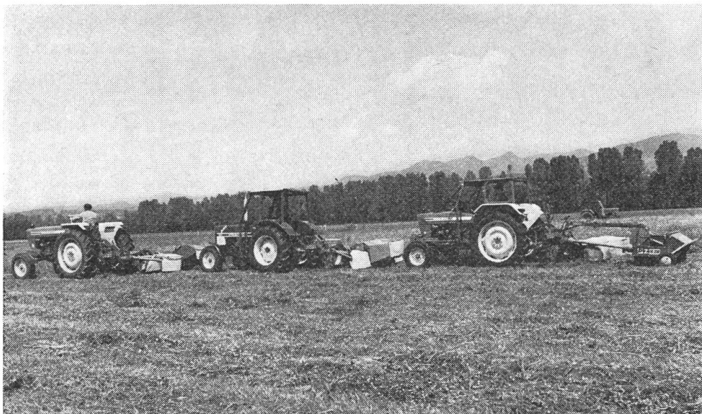
Ein Teil des vielseitigen PZ-Angebotes. Rotormäher 1,85 m mit aufgebautem Knicker. Falazet 1,85 m mit aufgebautem Walzenquetscher. Falazet 2,3 m mit gezogenem Knicker.
