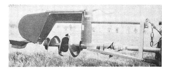
Das Kernstück einer Grabenfräse ist das Arbeitswerkzeug: die konische Schneckenfräse, eine Kombination aus Rechts- und Linkswindungen, die mit auswechselbaren Messern aus hochverschleissfestem Spezialstahl bestückt sind.
