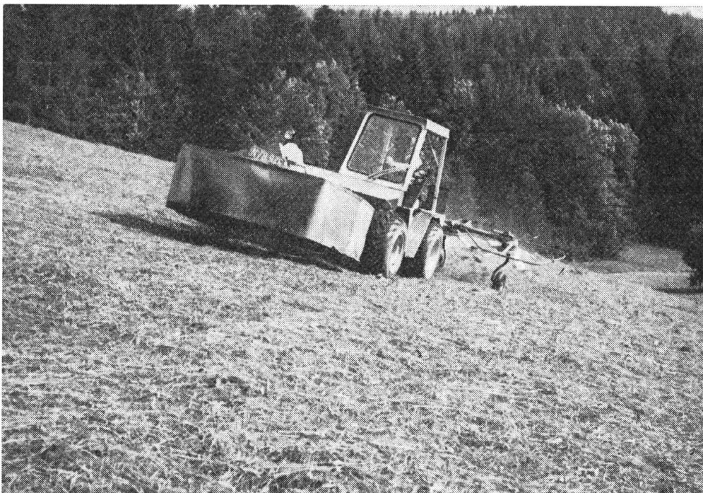
Abb. 5: Allradantrieb sowie synchronisiertes Wechsel- und Gruppengetriebe kennzeichnen die Schweizer Ausführung.
