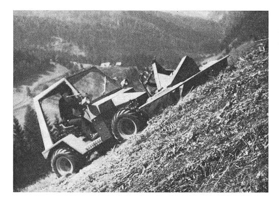
Abb. 6: Die stärkste der hangspezifischen Zweiachsmaschinen mit wassergekühltem Vierzylinder Schnelläufer-Dieselmotor.
