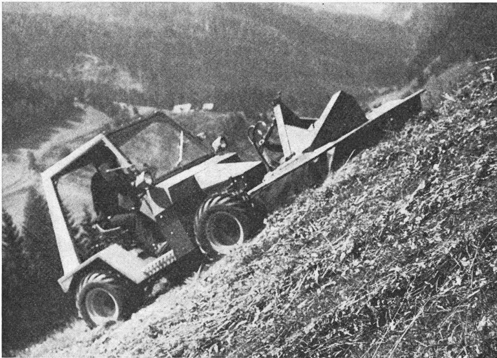
Abb. 6: Die stärkste der hangspezifischen Zweiachsmaschinen mit wassergekühltem Vierzylinder Schnellläufer-Dieselmotor.
