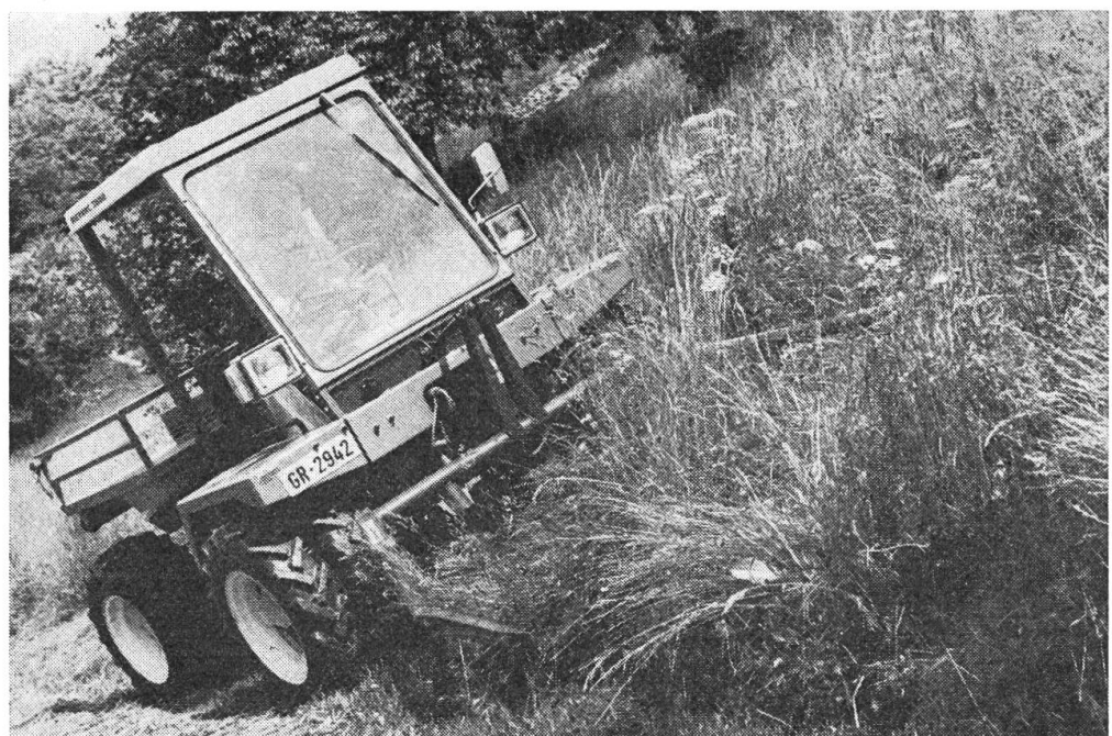
Abb. 4: Hecklenkung und hohe Mähleistungen kenn- zeichnen diese Maschine.
