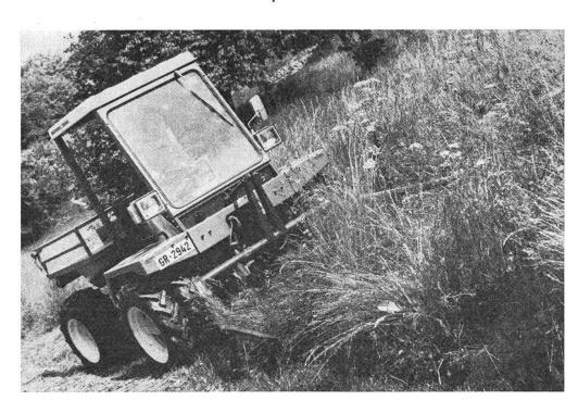
Abb. 4: Hecklenkung und hohe Mähleistungen kennzeichnen diese Maschine.
